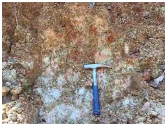
Foto 52 Solo argiloso, cinza claro, com pigmentação avermelhada em mais 50% da massa de solo na porção superior. Porção inferior exibe solo gleizado de cor cinza clara. Córrego Veredinha, afluente do córrego Vereda Grande, tributário da margem direita do ribeirão Entre Ribeiros.
